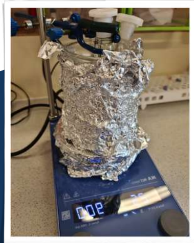
Şekil 1'de dijital manyetik karıştırıcıda kurulan sentez düzeneği görülmektedir.
